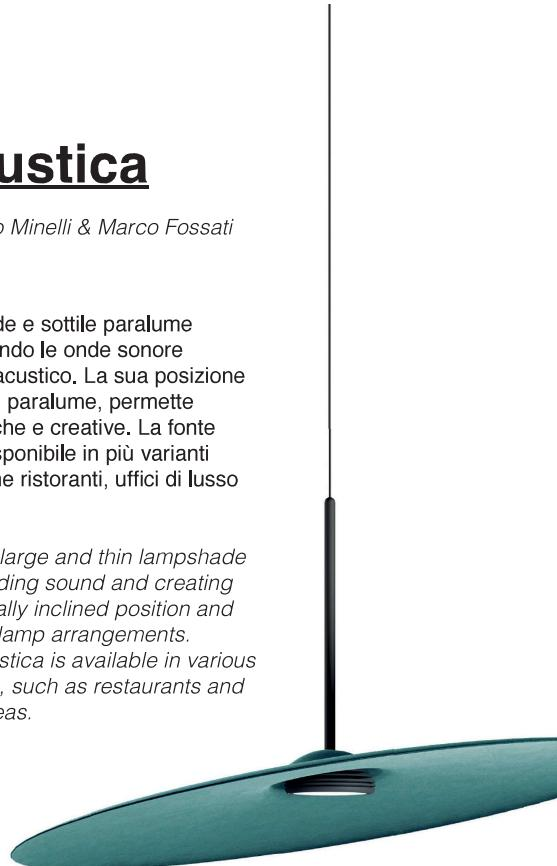
La collezione Acustica è costituita da due sospensioni per interno con proprietà di assorbimento acustico, di diametro da 90 cm o 120 cm. La calotta è realizzata in PET riciclato, con struttura in alluminio anodizzato nero e diffusore in PMMA sabbiato. La sorgente LED è disponibile dimmerabile 1-10V, DALI/PUSH o IGBT/TRIAC con alimentatore integrato. Tutte le versioni sono ad alta efficienza e ripple free.
